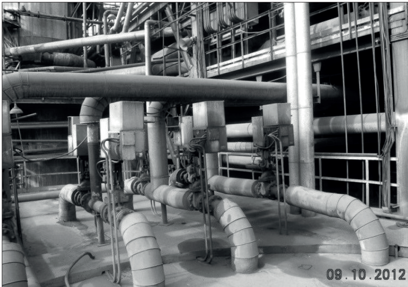
Slika 23. Elektrohidraulični pogoni i servomotori u Tvornici glinice Birač u funkciji i nakon više od 30 godina
