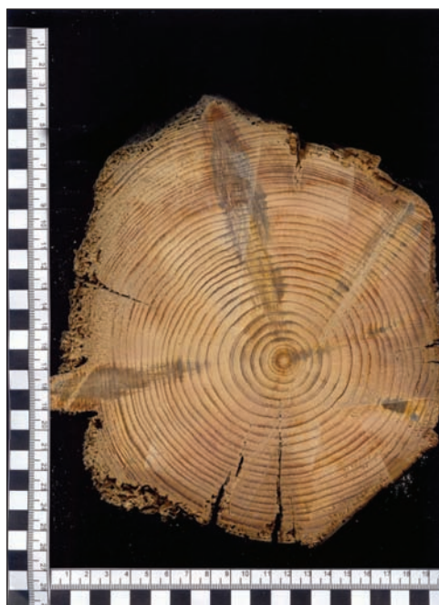
Sl. 13. Presjek grede drvenog serklaža iz donjih etaža zapadnog pročelja kule Tara (uzorak br. 11)
