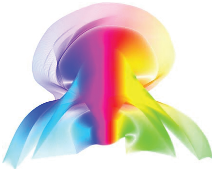
Slika 7. 3D model oblaka rasipnog zračenja kreiranog na osnovu mjerenja rasipnog zračenja u pojedinim ravnima koordinatnog sistema i rekonstrukcijom iz projekcija izodoznih krivulja iz svake ravni koordinatnog sistema
