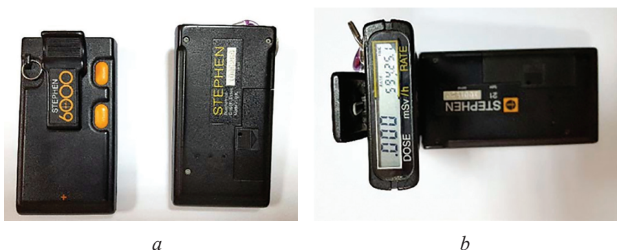
Slika 1. Dva Stephen 6000 series digitalna dozimetra korištena prilikom mjerenja (a, b)
