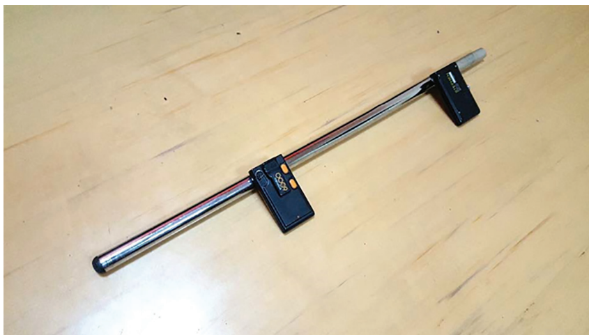
Slika 2. Stephen 6000 digitalni dozimetri postavljeni na nosač i spremni za mjerenje. Na istoj predefinisanoj liniji mjerenja, vršena su simultano četiri mjerenja zbog položaja dozimetara na nosaču. Na dužini od jednog metra, jedan dozimetar na udaljenosti od 10 cm, a drugi dozimetar na udaljenosti od 70 cm od desnog kraja nosača. Obrtanjem nosača za 180 stepeni, detektori postaju udaljeni 30 i 90 cm od desnog kraja nosača. Na predefinisanoj liniji mjerenja registrovane su vrijednosti na 10, 30, 70 i 90 cm.
